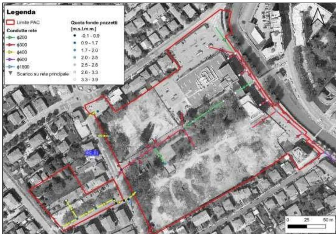
Figura 7 Inquadramento rete di drenaggio esistente ricostruita.
