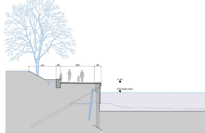
PROGETTO SEZIONE DELLA PASSEGGIATA VALENTINIS CON PASSERELLA GALLEGGIANTE E ASTE DI ORMEGGIO, scala 1:100
